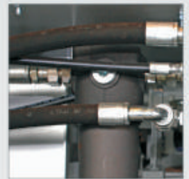
PARKER液压软管 市场上最好的，可以承受4倍的机器工作压力
