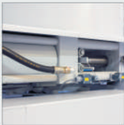
主压缸 带有PARKER密封件，搭接式外壳和螺杆活塞与箱式气缸具有相同的构造标准
